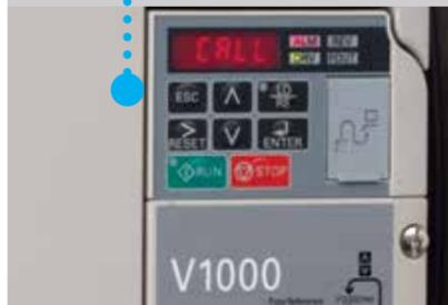
Variateur de vitesse de rotation de l'agitateur, sur une plage allant de 7 à 70 Herz. Commandé par l'intermédiaire de l'API, il permet d'obtenir un sanglage parfait effectué en fonction des caractéristiques de l'appareil, des ingrédients et des proportions ainsi que la quantité produite. Une nouvelle fonction permet de sélectionner la gestion automatique de l'extraction de la glace, de manière à maintenir la résistance de la glace à la fusion du début à la fin de l'extraction.
