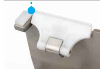
La résistance particulière du matériau de fabrication utilisé, certifié CE pour usage alimentaire, associée à l'inclinaison spécifique au point de contact du cylindre et au ressort haute résistance exclusif, permettent d'obtenir un effet de racleur de la surface du cylindre garantissant une haute efficacité thermique et une diminution notable de la consommation d'énergie.
