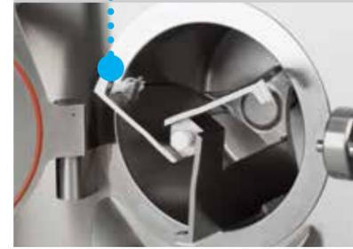
Le volume du cylindre en centimètres cubes est distribué en fonction d'un rapport précis entre le diamètre et la profondeur du cylindre, étudié et testé dans le but d'obtenir une parfaite synthèse entre le rendu frigorifique, la vitesse de congélation et de micro-cristallisation de l'eau et l'optimisation de l'incorporation de l'air.
