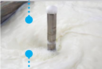
Le système de chauffage est à bain-marie, avec circulation continue du liquide. Associée à la gestion des résistances par l'API, cette solution permet d'obtenir une température uniforme et précise, notamment lorsque l'on travaille avec 30% de la capacité de production, pour éviter tout risque de brûlure de l'appareil ou des parois de la machine.
