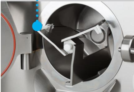
Le volume du cylindre en centimètres cubes est distribué en fonction d'un rapport précis entre le diamètre et la profondeur du cylindre, étudié et testé dans le but d'obtenir une parfaite synthèse entre le rendu frigorifique, la vitesse de congélation et de micro-cristallisation de l'eau et l'optimisation de l'incorporation de l'air.
