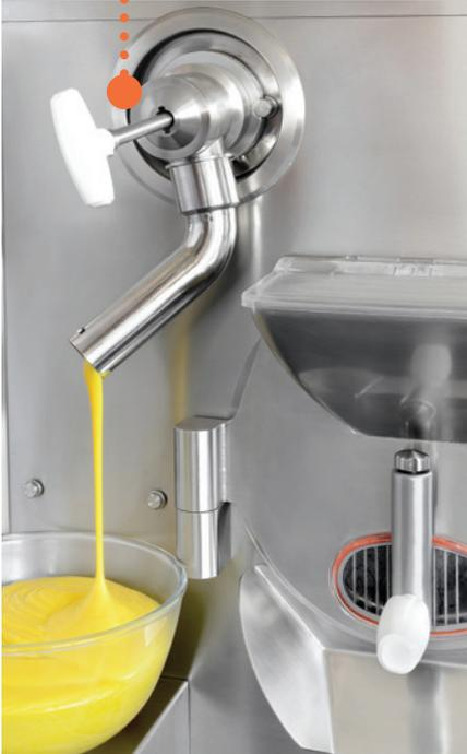
Robinet de grande taille, diamètre utile de 4 cm, pour le transfert direct du produit dans le cylindre de refroidissement, y compris pour les mélanges les plus denses: durée de transfert maximale de 15 secondes pour 7 kg de produit de haute densité.
