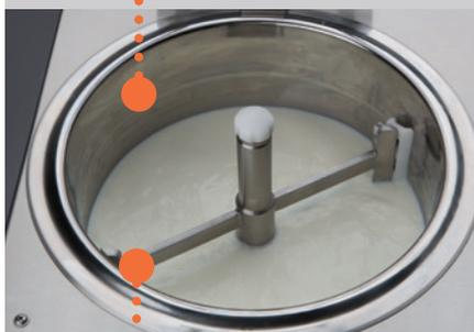
Le rapport entre le diamètre et la profondeur de la cuve crée un "récipient technologique" ayant une base très large, capable d'optimiser l'échange thermique sur le fond sans brûler ou endommager le produit se trouvant dans la cuve. L'agitateur est équipé d'un système contre-mélangeur breveté qui peut être démonté rapidement et facilement. Système de raclage uniforme sur toute la surface du cylindre, pouvant être facilement démonté et lavé.
