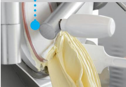
L'utilisateur peut sélectionner l'extraction automatique de l'appareil avec variation automatique de la vitesse de rotation de l'agitateur, pour maintenir la glace résistante à la fusion du début à la fin de l'extraction. Le rythme des accélérations est personnalisable et cette solution s'avère particulièrement pratique pour l'extraction des goûts marbrés.
