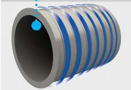
Système de détente directe du gaz réfrigérant sur le cylindre de sanglage par spirale creuse à diamètre variable progressif, pour optimiser le rendu frigorifique sur toute la surface du cylindre.
